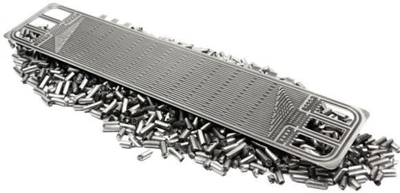
graphitische Bipolarplatte; Projekt: IGF-Vorhaben 22342N faserverstärkte Compound-Folien-Bipolarplatten (Quelle: ZBT GmbH)
