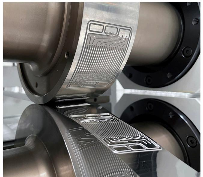
Anlage zum Hohlprägwalzen des Fraunhofer IWU; Projekt BPPflexRoll (Quelle: Fraunhofer IWU)
