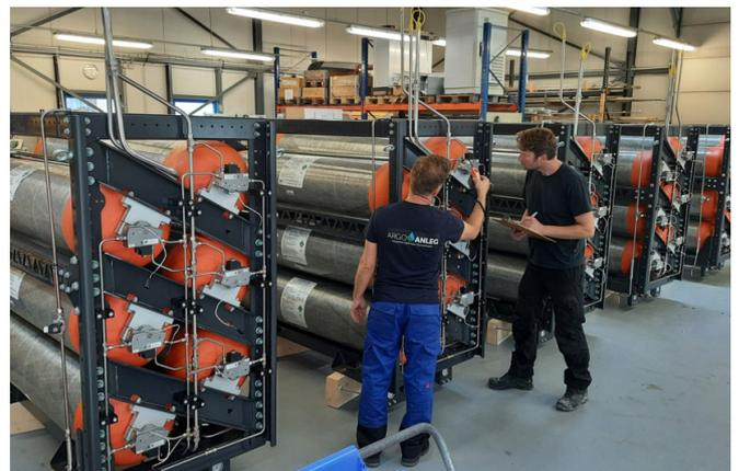
Wasserstofftanksystem für mobile Anwendungen (Quelle: Argo-Anleg GmbH)
