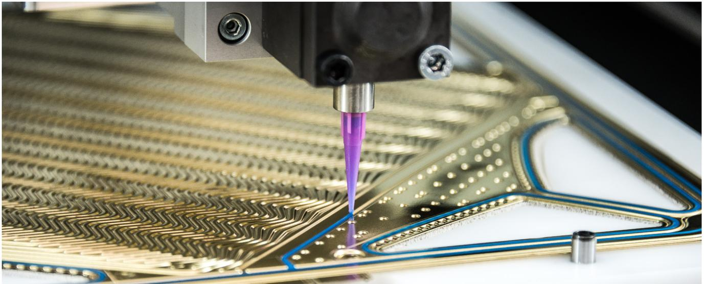
Dichtungsapplikation mittels Dispenser (Quelle: ZBT GmbH)
